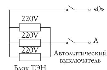
Рисунок 13. Схемы соединения блока ТЭН.
